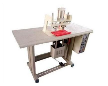
特点:利用超声波焊接,免用针线,省去频繁换针线的麻烦,没有传统线缝合的断线接头情况,还可对纺织品进行整洁的局部剪切与密封。缝合的同时也起到了装饰的作用,粘固力强,可达到防水效果,压纹清晰,
